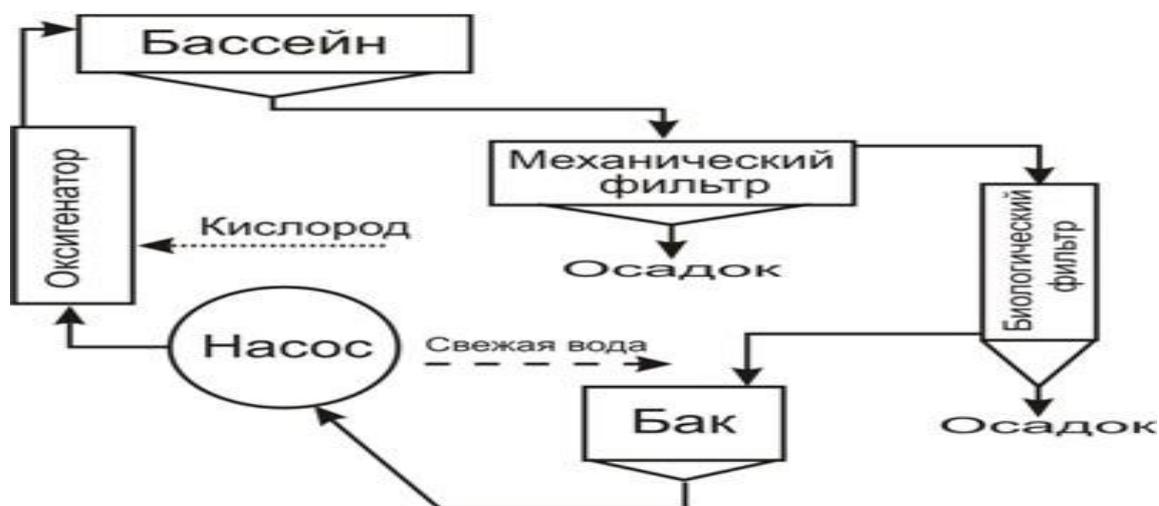
**Рисунок 1. Схема установки с замкнутым циклом водоснабжения**
